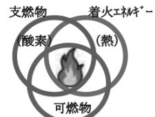
一方、煙草の火は700℃から800℃、近年流行の加熱煙草はメーカーによって異なりますが350℃以下とされており、可燃物の材質によっては着火させることができるエネルギーを持っています。IHクッキングヒーターについては焼き物調理する場合に着火温度に達する可能性があります。つまり炎が見えなくてもヒーター等の熱源は火災を発生させる可能性があり、火気として取り扱う必要があります。
